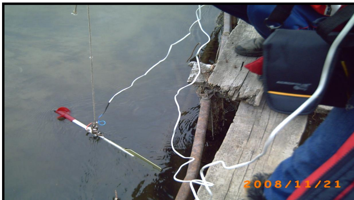
Фото 2. Измерение скорости потока р. Чумляк с помощью прибора ИСП-1м
