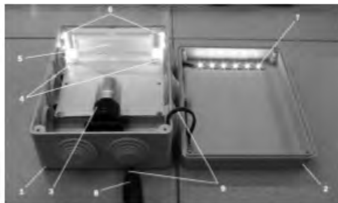
Рис. 2. Устройство анализатора токсичности «TrackTox»: 1) корпус прибора; 2) крышка; 3) видеокамера; 4) фиксаторы тестовой камеры; 5) тест-камера; 6) боковые светодиодные осветители; 7) верхние светодиодные осветители; 8) USB-кабель передачи видеосигнала на компьютер; 9) кабель электропитания.
