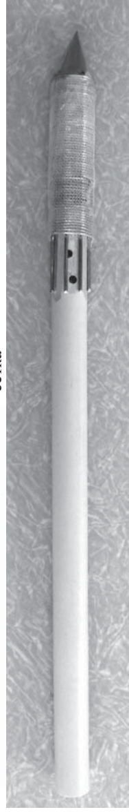
Рис. 8. Фильтр дырчатый для механической очистки воды от взвешенных веществ: 1 – труба, 2 – обмотка алюминиевая, 3 – стальные прутки (опорная проволока), 4 – отверстия, 5 – наконечник металлический, 6 – сетка
