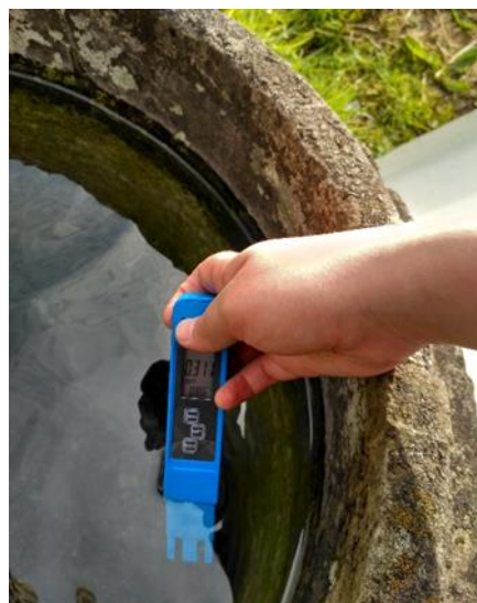
Фото 2.2 Измерение минерализации родниковой воды
