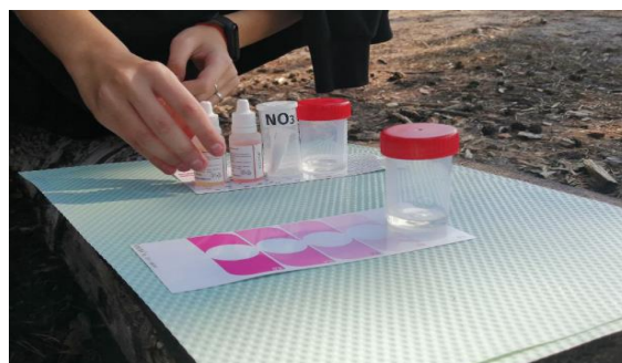
Рис. 8. Химический анализ воды набором НИЛПА.
