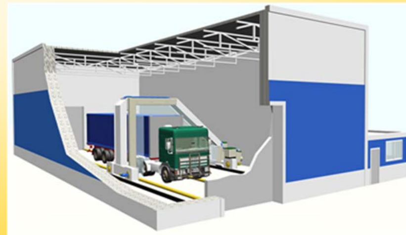
Рис. НИИЭФА им. Д.В.Ефремова, ЭФАСКАН, инспекционный комплекс для таможенного контроля транспортных средств и контейнеров
